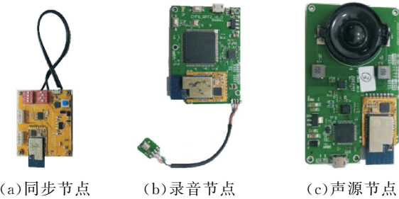
图 16 异步定位实验硬件设备图
